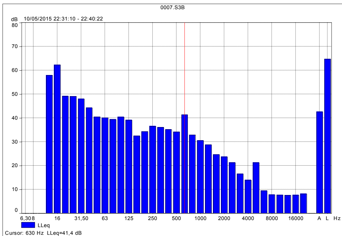
Figura 7.2. Espectro em bandas de terços de oitava registado no Local de Avaliação Acústica P5 (primeira amostra recolhida no período de entardecer)
